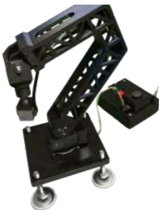
自社開発の作業アーム 遠隔操作や遠隔監視も可能
