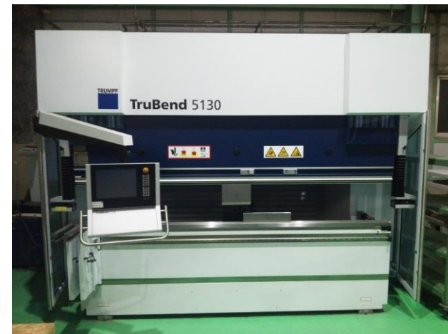
プレスブレーキ ～高速・高精度 の折り曲げを実現～
