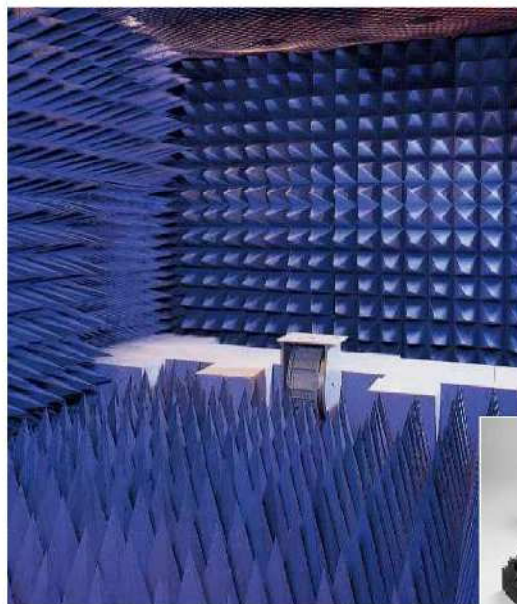
電波暗室 [電波吸収体 (導電性ポリエチレンフォーム)] Anchoic chamber [radio wave absorber (conductive polyethylene foam)]
